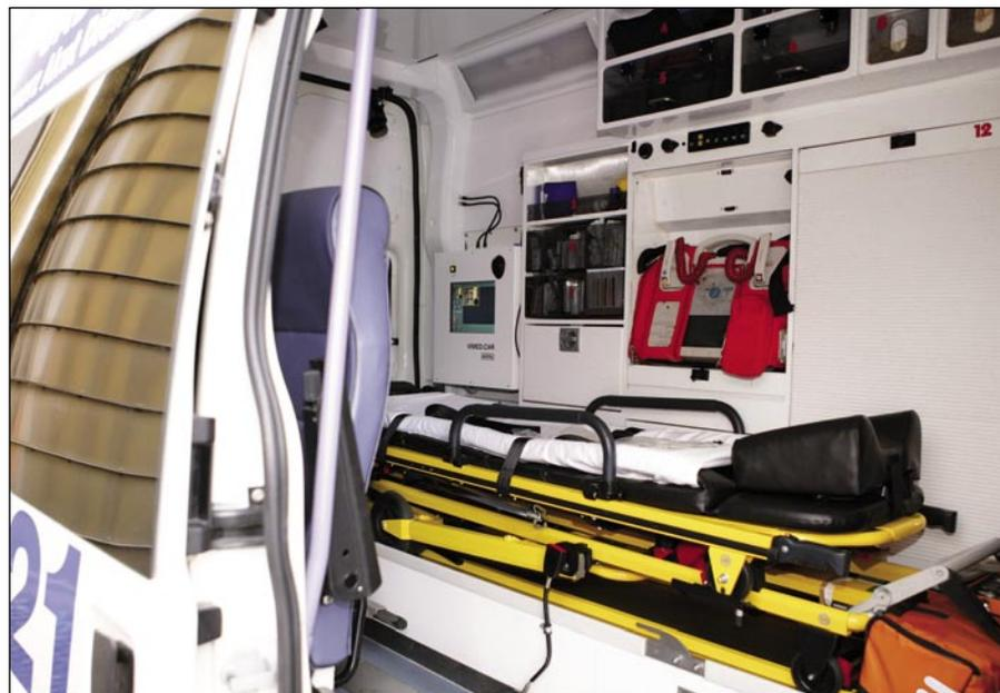
**Abbildung 2:** Der Rettungswagen ist mit dem Telemedizinsystem VIMED®CAR ausgestattet, entwickelt im Rahmen des vom Zukunftsfonds Berlin geförderten Projektes StrokeNet. Foto TSB/Willnauer
