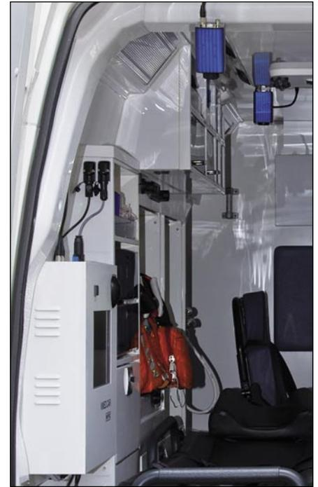
**Abbildung 3:** Blick in den Rettungswagen mit eingebautem System VIMED®CAR, Foto MEYTEC GmbH
